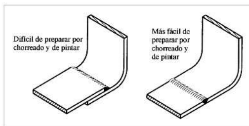
Figura 87.4.a Prevención de la acumulación de agua y suciedad
